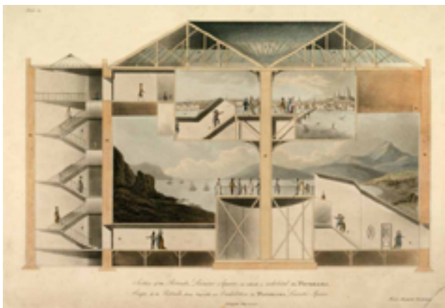
Разрез ротонды на Лестер-сквер архитектора Роберта Митчелла, где экспонировалась круговая панорама. 1801 Из издания: Mitchell R. Plans and in Perspective, with Descriptions, of Buildings Erected in England and Scotland: etc. London: Printed by Wilson & Co, 1801
